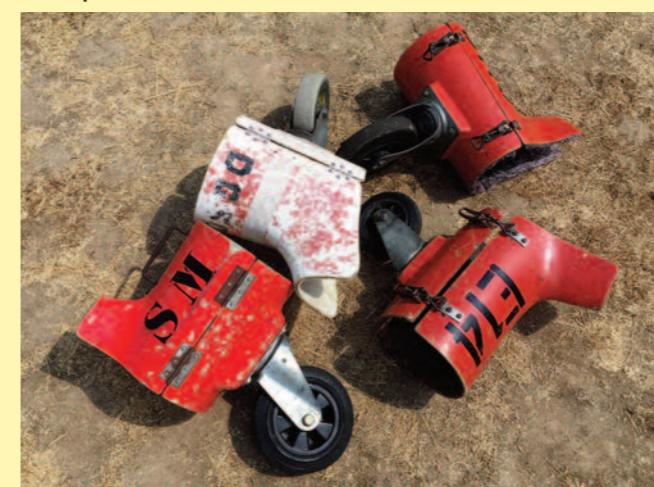
Pour remorquer les planeurs en piste, des trolley sont utilisés à l'arrière du planeur pour faciliter son déplacement. Une fois le planeur en place, il faudra retirer ce trolley.
